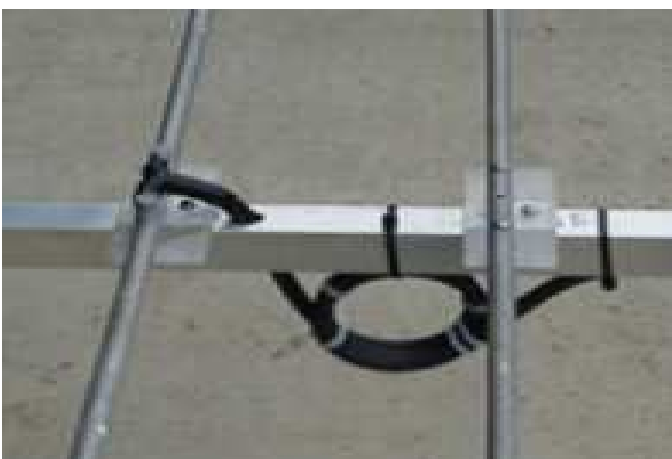
Fig. 8: balun 1:1 realizzato avvolgendo 4 spire del cavo coassiale di discesa su un tubo Ø50mm usato come sagoma. Da notare il passaggio del cavo attraverso il boom ricavato il più vicino possibile al punto di alimentazione.
