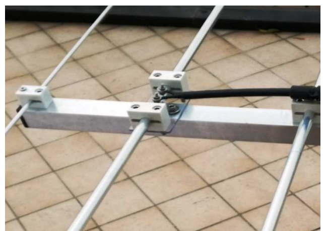
Fig. 9: balun 1:1 realizzato con uno spezzone di cavo coassiale su cui sono state infilate almeno 10 ferriti di diametro congruente a quello del cavo e ricoperto da guaina termo-restringente (si noti il rigonfiamento vicino al connettore, a destra).
